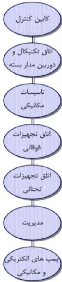
دیاگرام عمودی برج کنترل
