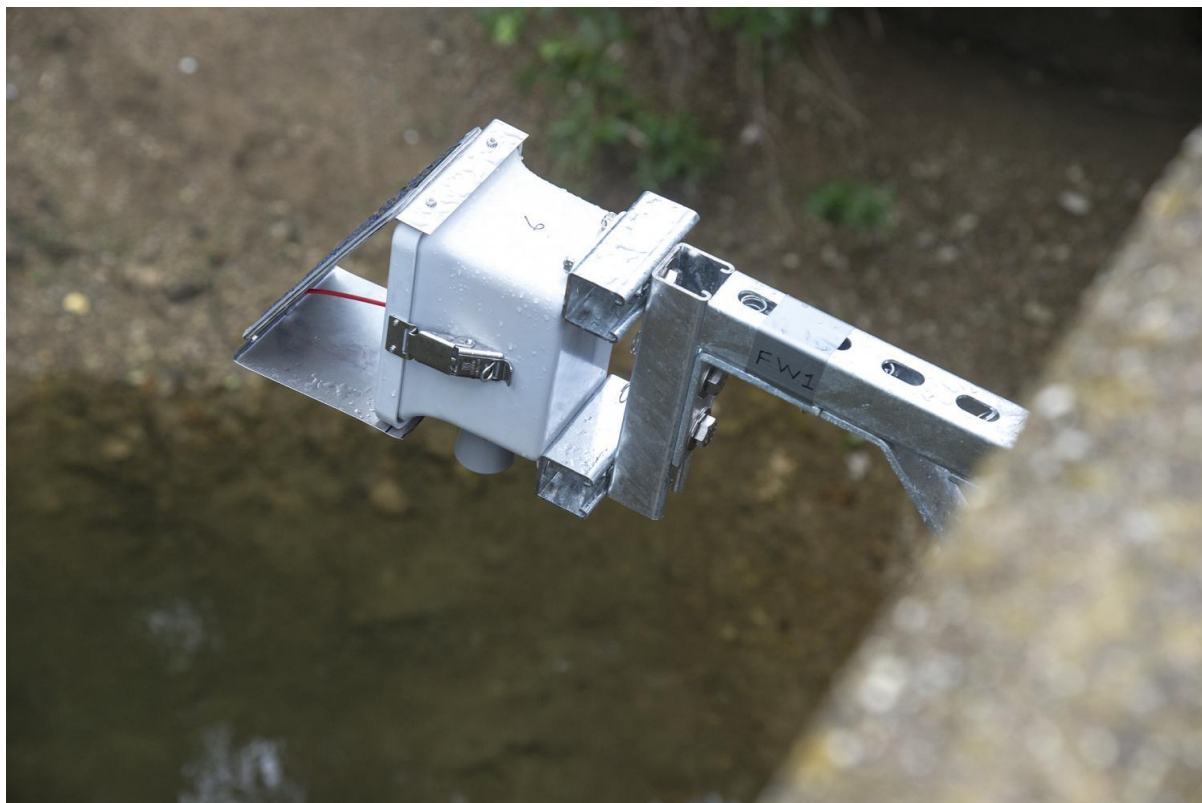
یک سنسور الکترونیکی که سیلاب ناگهانی را در پروژه تحقیقاتی سئو اندازه گیری می‌کند.
