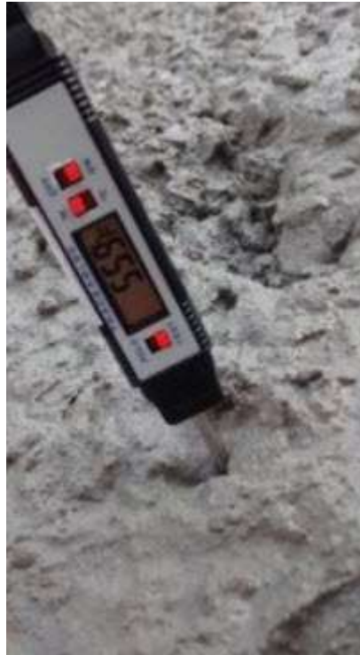
دماسنج کالیبره شده دمای بتن در محل را کنترل می‌کند.
