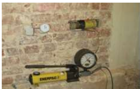
شکل ۴) آزمون برشی طبق روش B در سمت چپ و روش C در سمت راست
