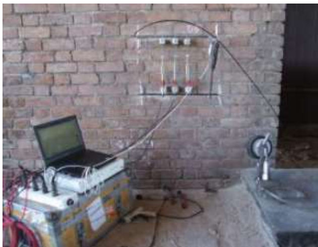
شکل ۳) انجام آزمون قابلیت تغییر شکل مصالح بنایی توسط جک‌ها و کرنش‌سنج‌های مخصوص
