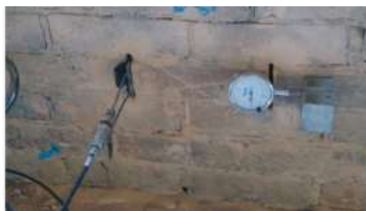
شکل ۴) آزمون برشی طبق روش B در سمت چپ و روش C در سمت راست
