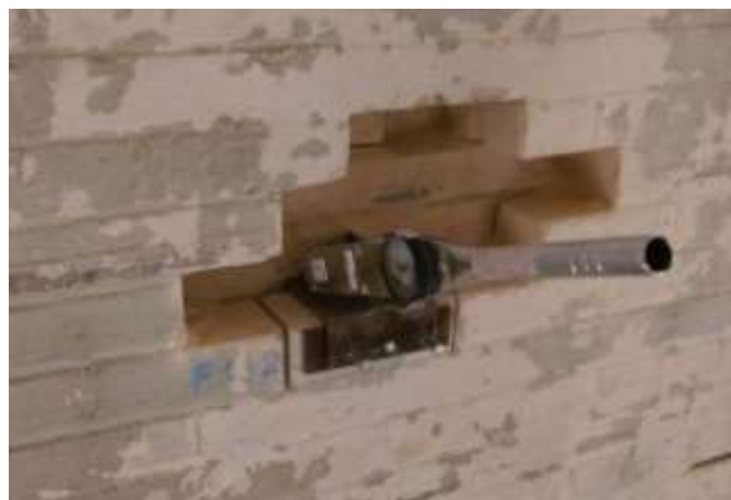
شکل (۲) آچار آزمایش پیوستگی بندکشی در کارگاه
