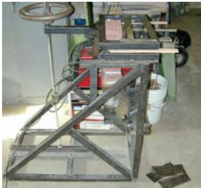
شکل (۱) دستگاه انجام آزمایش تعیین مقاومت خمشی بندکشی
