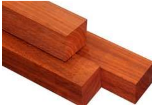
شکل ۱۱. چوب پداوک آفریقایی مقاوم در برابر حمله موربانه
