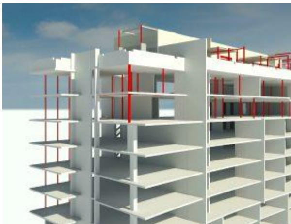
مدل Revit از دال‌های پس کشیده آویزان پنت هاوس و دال‌های انتقال پس کشیده سقف
