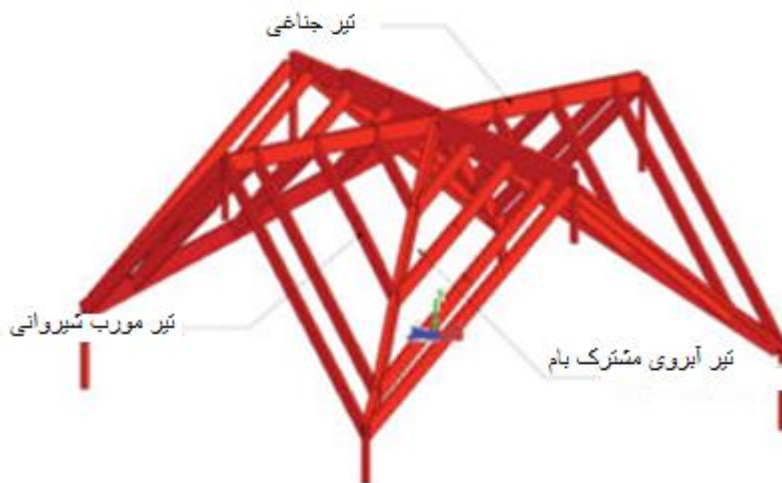
شکل ۳. نمونه‌ای از اشتراک بار بین اعضا در یک سقف چوبی
