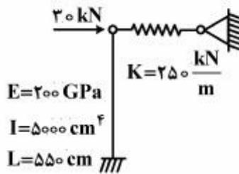
۲۰- در سیستم سازه‌ای مطابق شکل، نیروی فنر بر حسب kN کدام است؟
