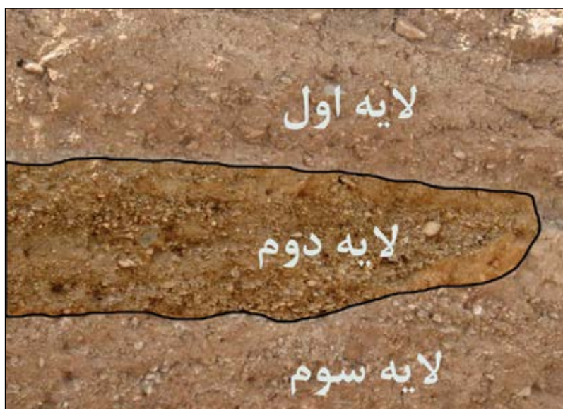
شکل ۸- تغییرات در لایه‌بندی خاک و محو شدن لایه دوم در امتداد افقی
