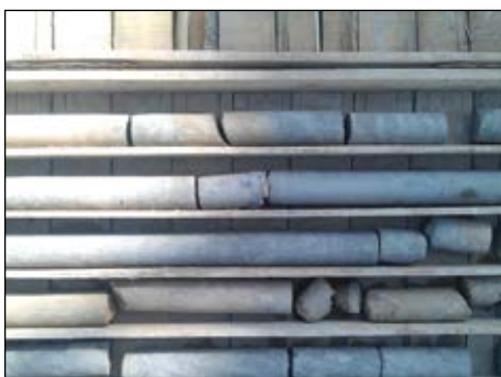
شکل ۲- حفاری به روش ماشینی؛ این روش بسته به جنس لایه‌ها، به روش‌های مختلفی مانند دورانی، ضربه‌ای و ... قابل انجام است.
