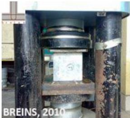
شکل-۲ (یک نمونه بتنی که در دستگاه سنجش مقاومت فشاری تحت آزمون مقاومت فشاری قرار گرفته و الگوی شکست آن)
