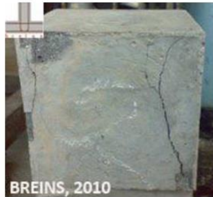
شکل-۲ (یک نمونه بتنی که در دستگاه سنجش مقاومت فشاری تحت آزمون مقاومت فشاری قرار گرفته و الگوی شکست آن)
