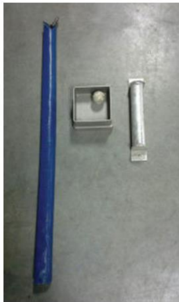
شکل ۴. میراگرها، از چپ به راست: میراگر زنجیر آویزان-میراگر مود اول، میراگر توپ سربی- میراگر مود دوم، میراگر تیر در قوطی- میراگر مود سوم.
