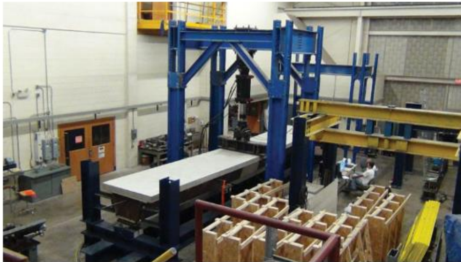
شکل ۳. راه اندازی آزمایش تجربی (نمونه کامپوزیت).
