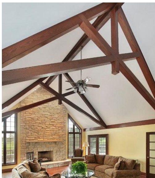
شکل ۴-۹. نمونه‌ای از یک خرپای قیچی در طراحی سقف
