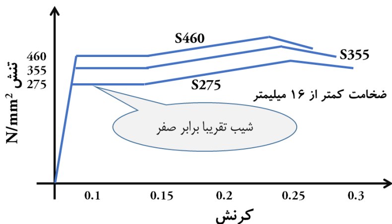
شکل ۱-۲۰ پروسه تسلیم فولاد و شیب صفر بعد از تسلیم.
