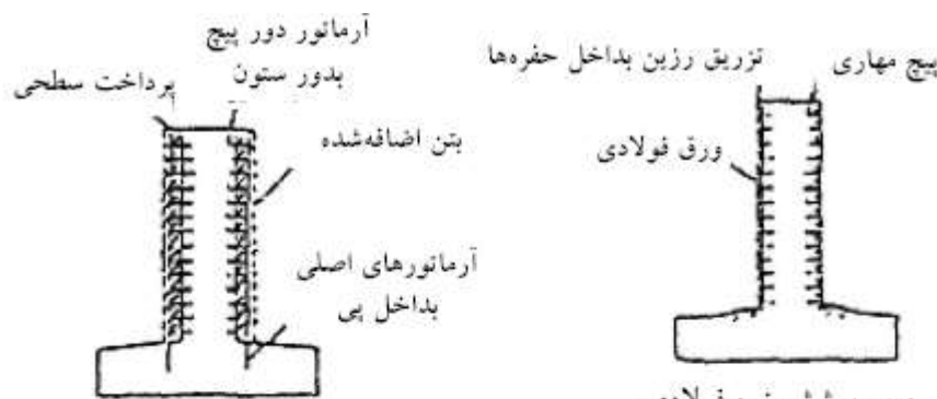
ب - پوشش زره فولادی مقاوم سازی لرزه ای پایه بتنی
