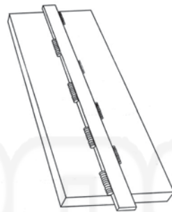
شکل ۱-۲۰- اجرای خال‌جوش‌های متناوب برای اتصال تسمه پشت‌بند.
